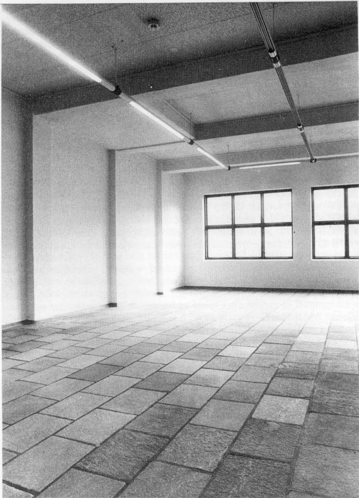
Utstillingsrommenes karakter av produksjonslokaler er ikke endret. Gulvene er skiferbelagt, veggene hvitmalt. Eswavarme over himling av akustiske plater. Alt elektrisk anlegg er skjult, mens belysningssystemet med lysende og prosjektørbærende elementer minner om meieriets tidligere rørsystem. (Foto: Eirik Østberg.)
